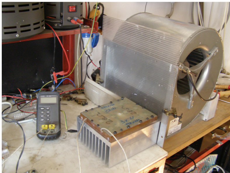
Prova di laboratorio/Laboratory: test heatsink
